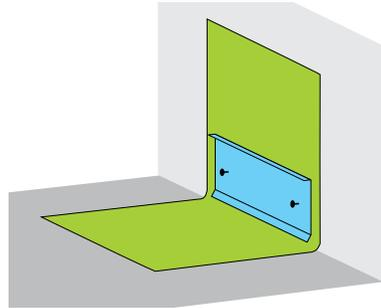
2. Avec un cutter, découpez ce qui dépasse du lé de bitume au niveau du bord supérieur du solin.
