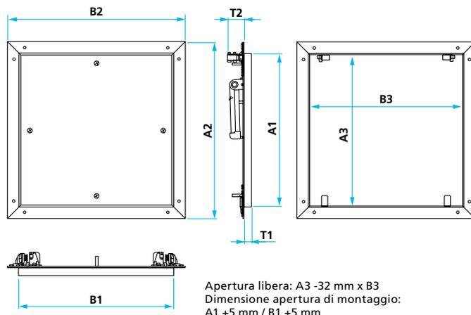
— L'inserto in cartongesso avvitato ne consente la sostituzione in cantiere
