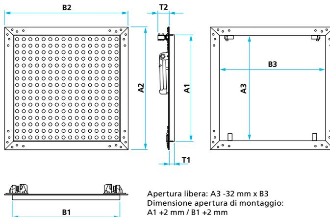
— Dimensione della botola configurata esattamente sul relativo disegno della lastra forata
